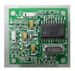
电子罗盘功能。本电子罗盘采用 SPI 接口,可输出 0<sup>0</sup>~359<sup>0</sup> 角度,并具有设置磁偏角及硬磁补偿功能。
