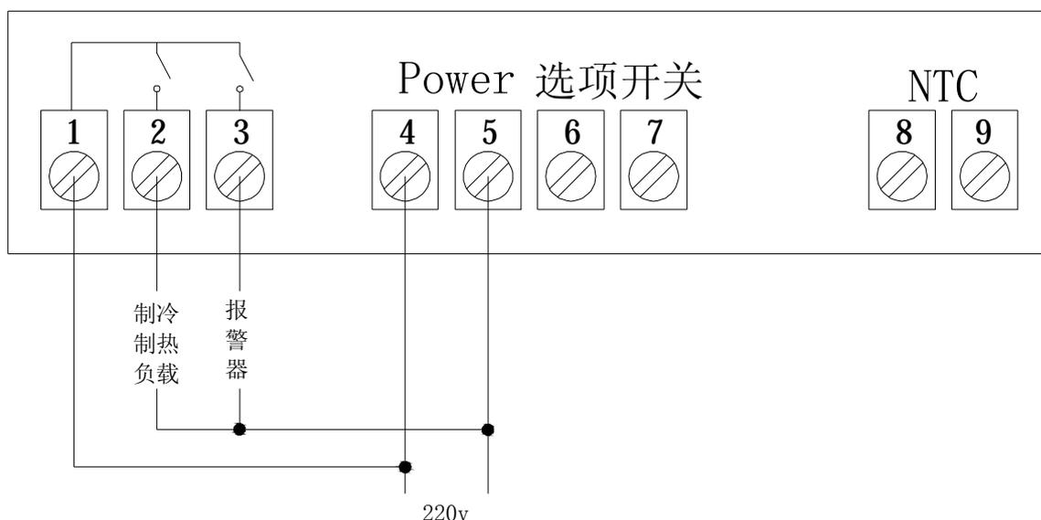
接线柱 1 和 2：制冷或加热输出,常开触点
