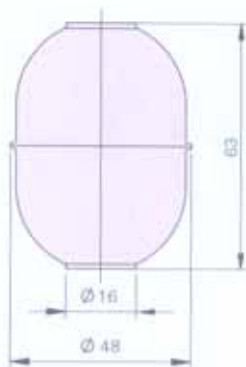
标准液面浮子( \phi 16 \times \phi 48 \phi \times 63 )
