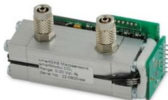
smartMODUL<sup>FLOW</sup> 型红外气体传感器基于单光束双波长红外测量技术及高精度数字处理技术，广泛应用于气体分析行业和工业过程控制。内部集成完整的漂移控制电路和温度补偿电路并配有坚固的铝合金气室和方便的管路接口。
