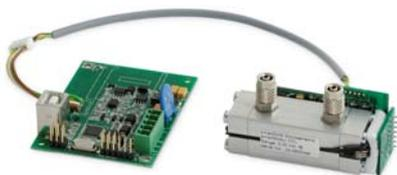
smartMODUL<sup>PREMIUM</sup> 型红外气体传感器基于单光束双波长红外测量技术及高精度数字处理技术，广泛应用于气体分析行业和工业过程控制。内部集成完整的漂移控制电路和温度补偿电路并配有坚固的铝合金气室和方便的管路接口。
