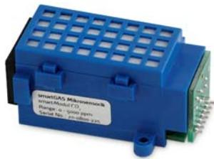
smartMODUL<sup>BASIC</sup>型红外气体传感器基于单光束双波长红外测量技术及高精度数字处理技术，广泛应用于空气质量检测和工业过程控制。内部集成完整的漂移控制电路和温度补偿电路。
