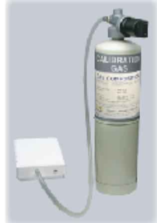
Quite la cubierta portuaria y conecte 2000 PPM CO2 gases de la calibración
