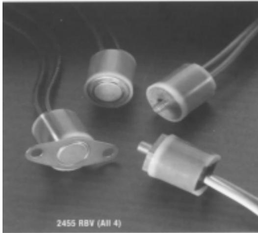
与开关的电和热都绝缘的，对温度敏感的双金属盘，用来驱动通常闭触点。当表面或环境温度增加到业经校正的双金属盘的工作设定点时，触点就打开。整个开关封闭在酚醛或陶瓷防尘外壳中，双金属盘由一金属热导端盖固定。设备由环氧树脂密封。
