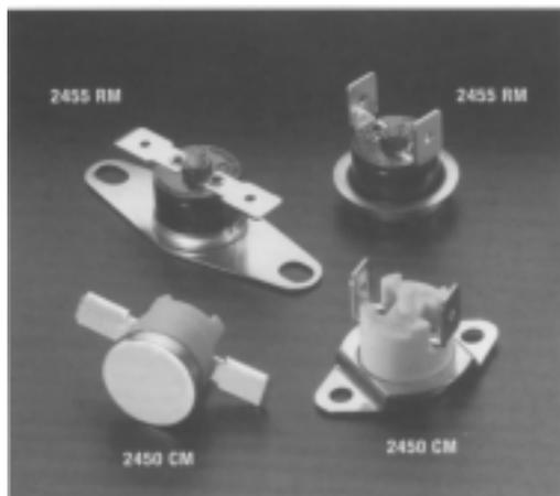
与开关之间电和热都绝缘的,对温度敏感的双金属盘,用以驱动常闭触点。当表面或环境温度增加到业经校正的双金属盘的突发起动工作点时,触点就打开。整个开关封闭在无尘的外壳里,双金属盘由金属热导端盖固定。
