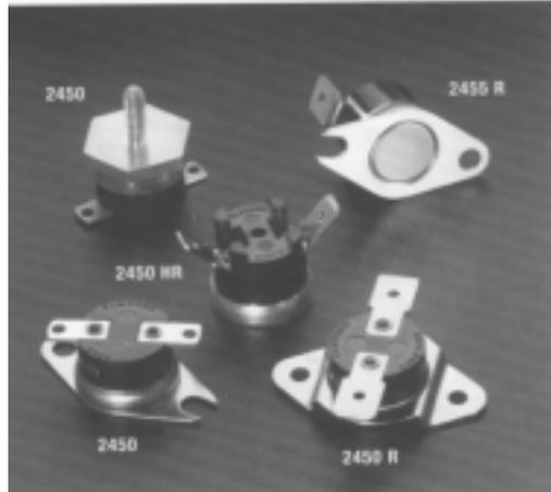
与开关之间电和热都绝缘的，对温度敏感的双金属盘，用以驱动常闭触点。当表面或环境温度增加到校正过的双金属盘的突发起动工作点时，触点就打开。整个开关封闭在酚醛无尘的外壳中，双金属盘由金属热导端盖固定的。
