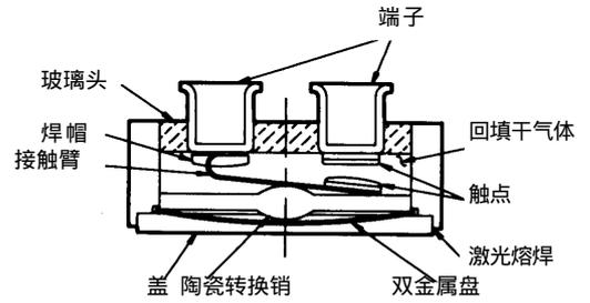
3153 系列薄壳型小型设计特别适用于要求小型化的使用场合。验收试验按 MIL-S-24236,表 III 要求进行。
