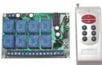
**学习对码方法：**一直按住学习按键大约 3 秒钟后，学习指示灯变亮，松开按键，然后按无线遥控器中的按键发射信号，这时指示灯变灭，既表示学习进去了。在此间没有任何操作，5 秒后 LED 熄灭自动退出学习状态。再次学习的时候重新按照以上的操作即可。
