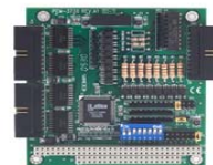
PCM-3730 32 信道隔离数字 I/O 模块
