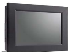
PPC-L156T 带 15" TFT LCD 和触摸屏的无风扇 工业平板电脑
