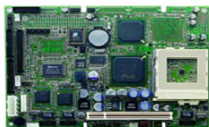
PCM-9576 Socket 370 架构 5.25" 单板电脑, 提供 3 网口, 支持 VGA/LCD
