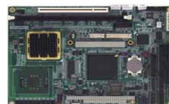
PCM-9587 板载 Intel® Celeron® M 600 MHz EBX 单板电脑
