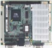
PCM-9377 VIA Mark 3.5 寸单板, 支持 VGA/LCD/LVDS/以太网/USB
