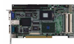
PCI-6881 PCI Pentium M 半长 SBC, 带 VGA/LCD/LVDS/千兆以太网
