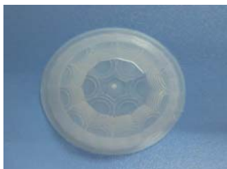
型号: 8603-5 焦距: 12 角度: 116° 距离: 5m 尺寸: \Phi 35
