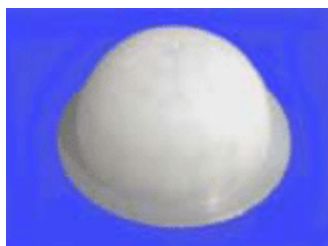
型号: 003 焦距: 13.50 角度: 180° 距离: 10m 尺寸: 外径 43 内径 35.2
