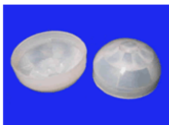
型号: 2814 焦距: 10.5 角度: 140° 距离: 6m 尺寸: \Phi 28 厚度:0.6
