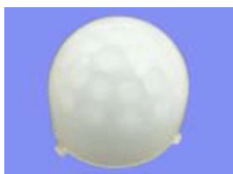
型号: 9002 焦距: 12 角度: 116° 距离: 7m 尺寸: 24*16.7
