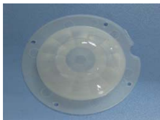
型号: 8605-3 外径: 45mm 内径: 32.5mm 焦距: 15mm 厚度: 0.7mm 角度: 360° 感应距离: 5m
