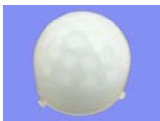
型号: 9002 焦距: 12 角度: 116° 距离: 7m 尺寸: 24*16.7
