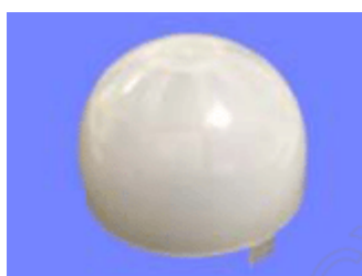
型号: NL-02 焦距: 10.05 角度: 100° 距离: 10m 尺寸: \Phi 23.5 高度 14.70
