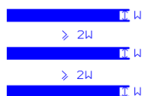
(a)离开邦定位后晶振线及频率较高的线路
