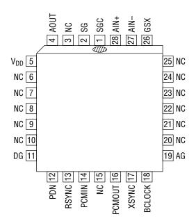
NC : No connect pin **28-Pin Plastic QFJ (PLCC)**
