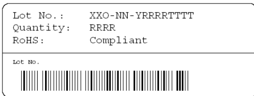
图12 卷轴上的标签: XX = 传感器型号 (21 for SHT21), O = 输出方式 (D = Digital, P = PWM, S = SDM), NN = 芯片版本, Y = 年的最后一位, RRR = 卷轴上的传感器数量除以10。TTTT = 追踪代码。
