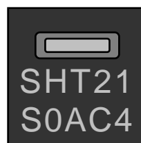
图 11 传感器上的激光标识。具体含义详见上文卷轴上面也贴有标签，如图 15 和图 16 所示，并提供了其他的跟踪信息。
