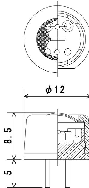
图 NAP-55A 结构，外观
