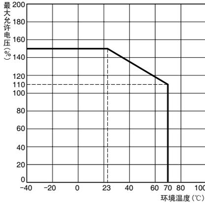
注. 最大允许电压为继电器线圈能承受的电压的最大值。
