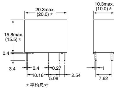
印刷基板加工尺寸 (BOTTOM VIEW)
