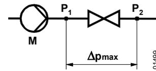
举例: 阀门进口的压力 P<sub>1</sub>: 500 KPa (5 Bar)
