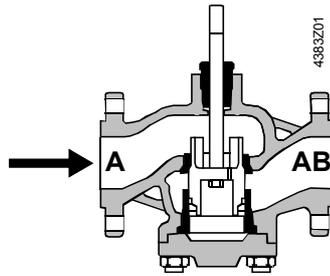
⚠ 二通座阀不可以通过拆除阀底的法兰式盲板来当作三通阀使用。
