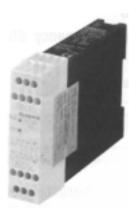
FF-SRS5924 急停模块设计成能在人员或机械有危险时用在急停电路上。这种细长外壳设备有两个配有正导向触点的安全继电器,以确保冗余。
