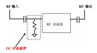
图 3 - 如果在设备的两侧都是 AC 耦合,提供 DC 对地基准
