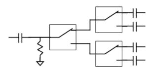
图 4- 用于 RF 开关级连的对地基准
