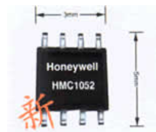
HMC1052 新一代二轴磁阻传感器
