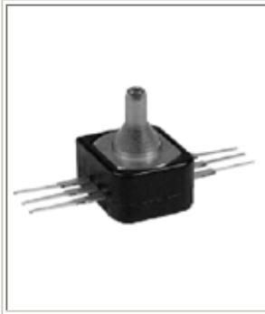
最新的经济型 40PC 产品是由 Honeywell/MicroSwitch 分部推出的最小体积放大压力传感器。完全校整和温度补偿，是霍尼韦尔压力产品中最坚固、适用温度最宽的传感器。另外，40PC 可与很大范围的介质兼容，从干燥空气和水到冷却液和机油。40PC 提供模拟放大信号输出，传感器利用了独创的单硅片的设计，把所有温度补偿、输出零点、满量程校整、放大功能集中在一块硅片中。
