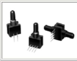
24PC 系列差压，表压和绝压/无放大，无补偿，2mA 恒流供电可以显著的改善灵敏度温飘，可以测量负压，正压，绝压。
