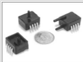
传感器可以用来测量绝压差压和表压，范围从 1psi（ASDX01DN）到 100psi（ASDX100）。绝压传感器具有一个内部的真空标准，其输出电压与绝对压力成正比。差压传感器允许将压力施加在检测膜片的两边，可以用在表压和差压的测量中。
