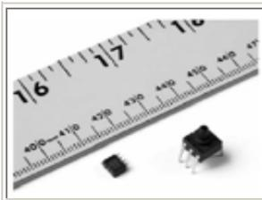
微型封装尺寸，可供表压型和绝压型，不带补偿和校准，压力范围自 0psi 至 100psi，响应时间一般为 1mS，两种封装形式：DIP 和 SOIC（双列式封装和小型集成电路），工作温度范围宽，表面贴装和通孔安装
