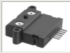
AWM40000 系列放大输出气体质量流量传感器, 多个集中安装 / O 形密封圈, 陶瓷流量管 (无引气管), 0-1000sccm, 塑料流量管 (无引气管), 0-6SLPM, 高共模压力 (150psi), 工作温度可至 125℃, 零点和满量程高稳定性<br>
